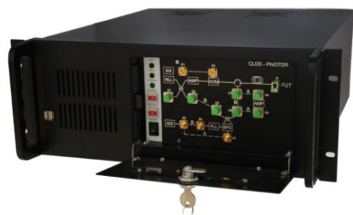
Fig. 1 CESNET modular phase OTDR.
