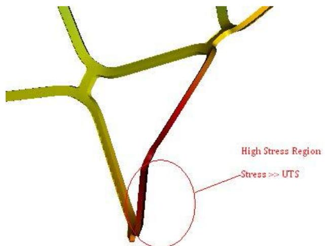
Fig. 10. von Mises stresses in PS stent
