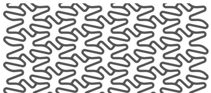
Fig. 8. Rolled-out ISMA stent
