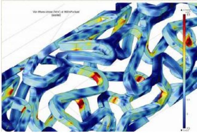
Fig. 11. von Mises stresses in an ISMA stent
