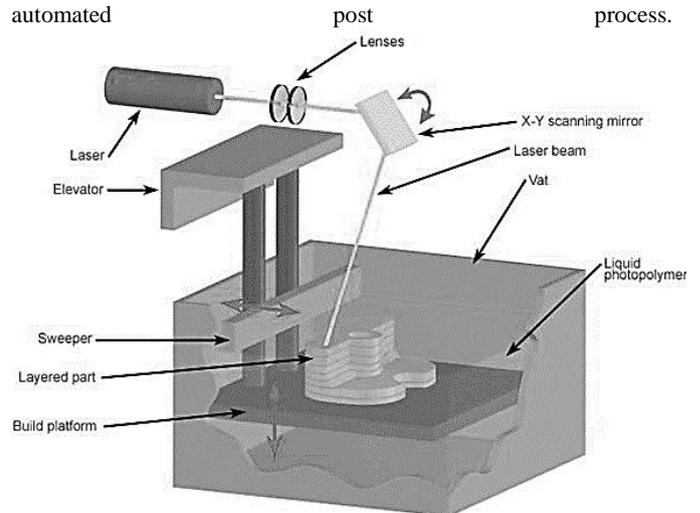
**Fig.2.3.** Stereolithography (SLA) – Schematic
