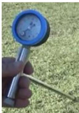
Fig. 11. Analog soil moisture meter
