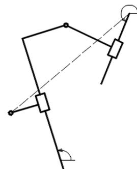
Fig. 10: Structure R-S-R-S
