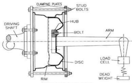
Fig. 3 Cornering fatigue test
