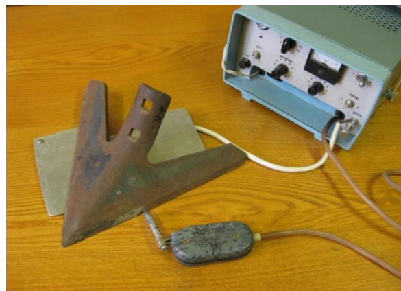
Рис.5. Устройство для электроискрового легирования.
