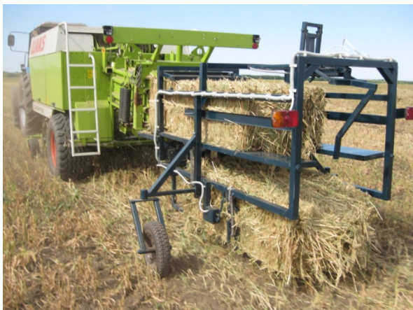
Фигура 3. Устройство для упорядоченной укладки тюков в работе
