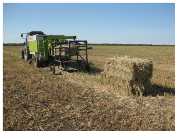
Фигура 5. Автоматическая укладка двоянного тюка на поле
