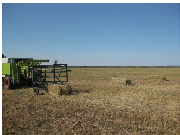
Фигура 4. Укладка тюков в ровные ряды поперек траектории движения пресс-подборщика
