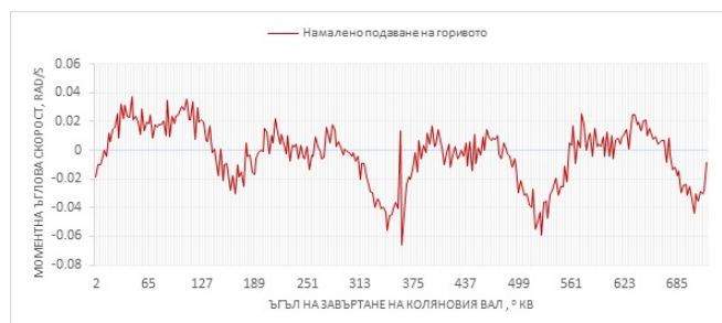
Фиг. 6 Характеристика на моментната ъглова скорост при неизправно състояние на двигателя (намалено подаване на горивото) в единия цилиндър
