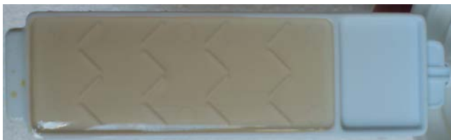
фиг.7 Състояние на теста за microbiологично замърсяване на свежото гориво от бензиноколонка
