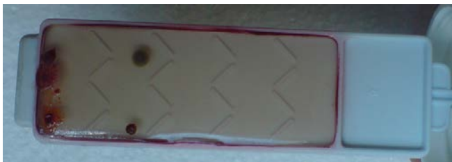
фиг.8 Състояние на теста за microbiологично замърсяване на горивото от цистерна за съхранение на гориво. Наличие на бактериално(червените петна)от едната страна на теста.
