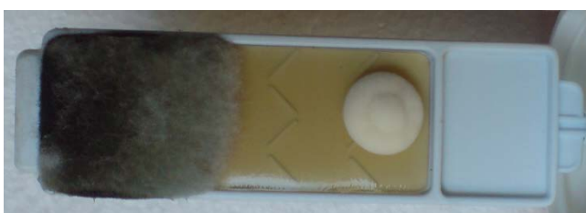
фиг.9 Състояние на теста за microbiологично замърсяване на горивото от цистерна за съхранение на гориво. Наличие на гъбично/плесенно замърсяване от другата страна.
