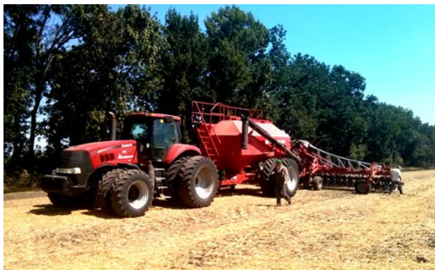
Рис.3. Подготовка к испытаниям модернизированного посевного комплекса Агро-Союз Turbosem II 19-60 на посевах люцерны (август 2014 г.)
