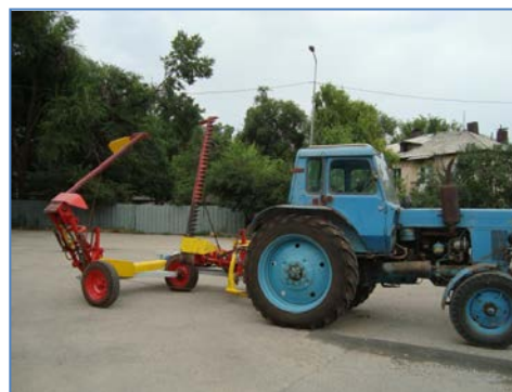
Рисунок 3 – Косилка двухбрусная прицепная КДП-4,0М
