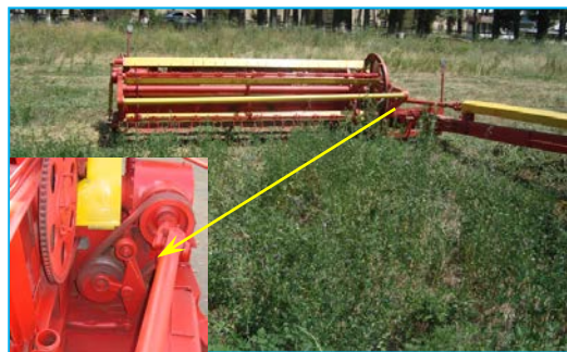
Рисунок 2 – Косилка-плющилка КП-3,0 с механизмом привода режущего аппарата
