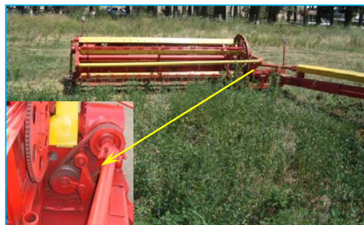
Рисунок 2 – Косилка-плющилка КП-3,0 с механизмом привода режущего аппарата
