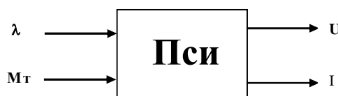
Фиг.1 Модел за изследване процеса на вибродъгово наваряване в защитни газове: \lambda е амплитуда на вибрациите; M_t – материал на електродния тел; U – параметри на електрическото напрежение; I – параметри на тока.
