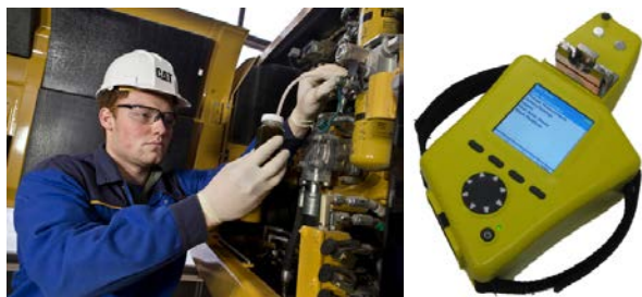
Фиг.3.Преносим прибор за оценяване състоянието на маслото
