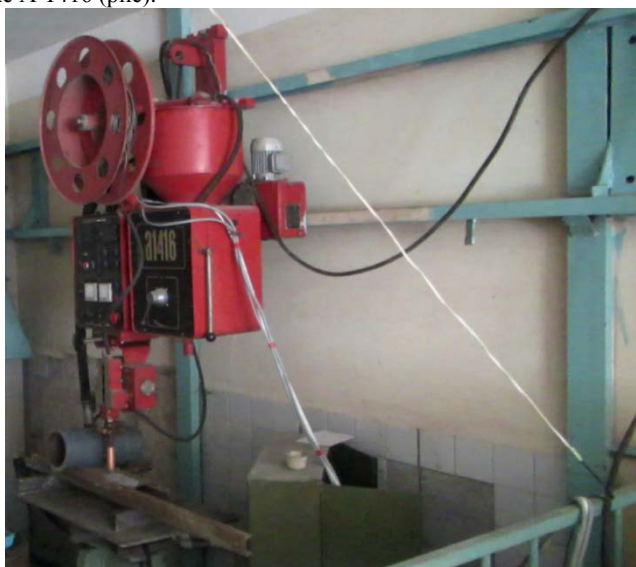
Рис. Модифицированная установка для автоматической наплавки деталей под флюсом.
