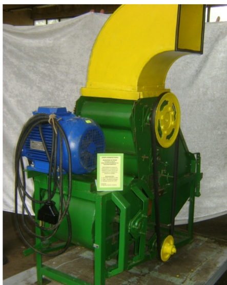
Снимка 3. Вършачка за сухоплодни култури - МССЗК, разработена в РУ “Ангел Кънчев”.
