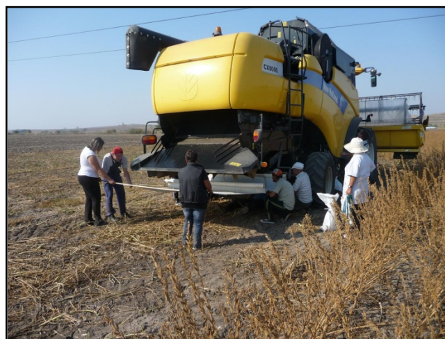
Снимка 1. Изследване на показателите на зърнокомбайн New Holland CX 8060 при прибиране на сусам в с. Крушево, Първомайско.
