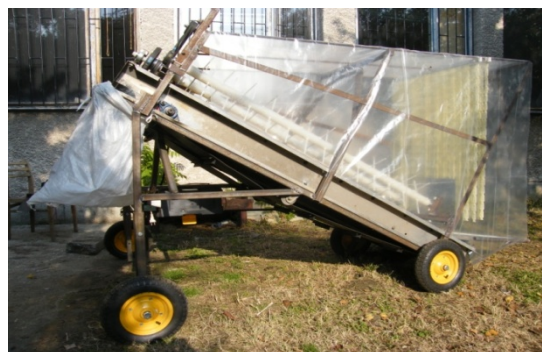
Снимка 4. Прототип за прибиране на сусамови кутийки чрез очесване, разработен в катедра Механизация при Аграрен Университет - Пловдив.
