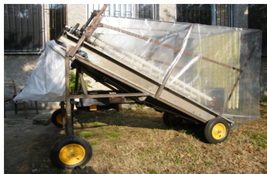
Снимка 4. Прототип за прибиране на сусамови кутийки чрез очесване, разработен в катедра Механизация при Аграрен Университет - Пловдив.
