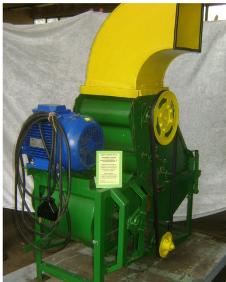
Снимка 3. Вършачка за сухоплодни култури - МССЗК, разработена в РУ “Ангел Кънчев”.
