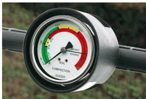
**Fig. 6. Hardness meter scales**
