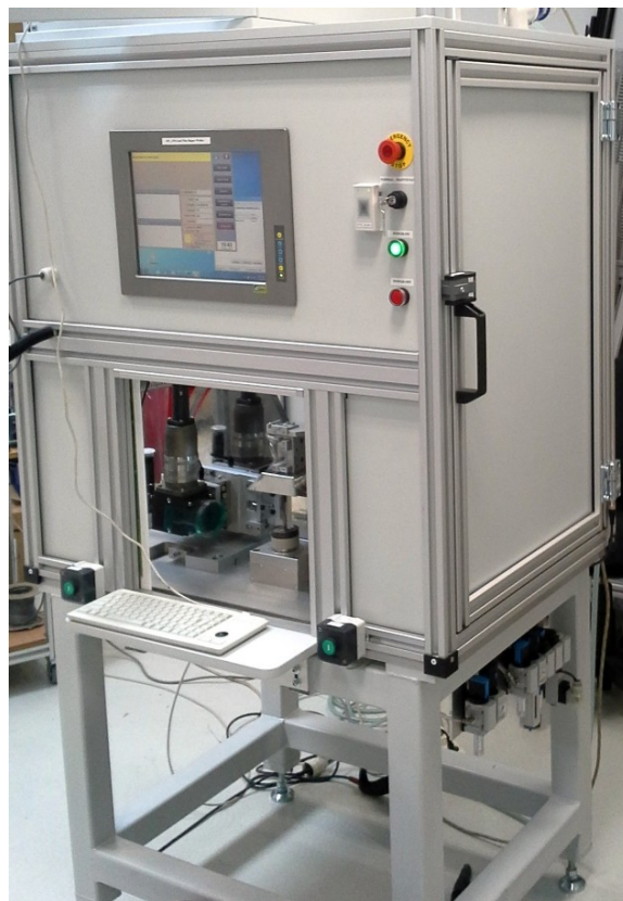
Фиг.2 Общ вид на автоматичната машина за лазерно заваряване.
