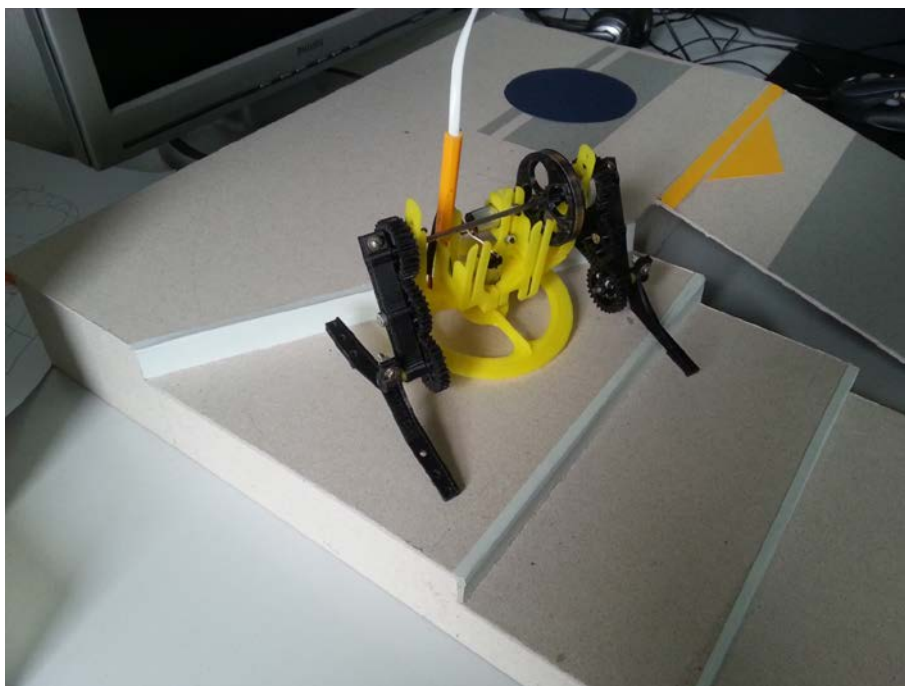
Фиг.3 Действащ модел със зъбно-лостов механизъм на краката
