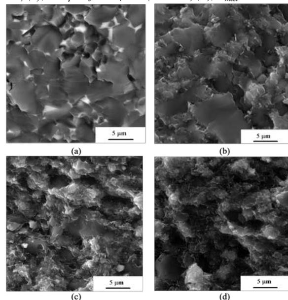
Fig. 5. Fracture surface of sintered ceramic composites: (a)  $\beta$ - $\text{Si}_5\text{AlON}_7$ - $\text{Y}_2\text{O}_3$  (5 wt %), (b)  $\beta$ - $\text{Si}_5\text{AlON}_7$ -BN (10 wt %), (c)  $\beta$ - $\text{Si}_5\text{AlON}_7$ -BN (20 wt %), and (d)  $\beta$ - $\text{Si}_5\text{AlON}_7$ -BN (30 wt %);  $T_{\text{max}} = 1750^\circ\text{C}$ .
