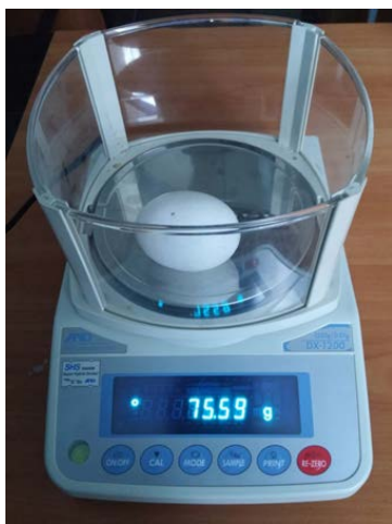
Рисунок 2 – Определение массы яиц на электронных весах марки DX-1200
