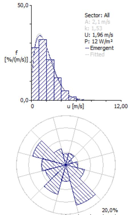
**Figure** Грешка! В документа няма текст със зададения стил.. Observed wind climate data and wind velocity histogram of Hakkari central station.
