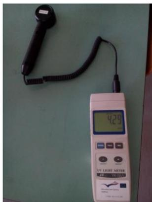
Fig. 3 Lutron YK-35UV UV meter
