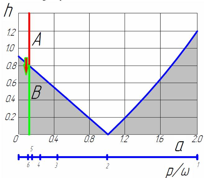
**Fig. 6.** Ince-Strutt Diagram.
